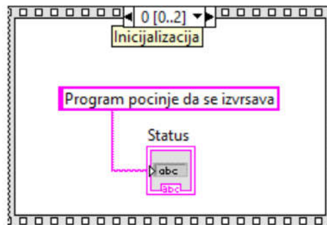
Sl. 2.2.7. Block Diagram programa sa Stacked Sequence strukturom
