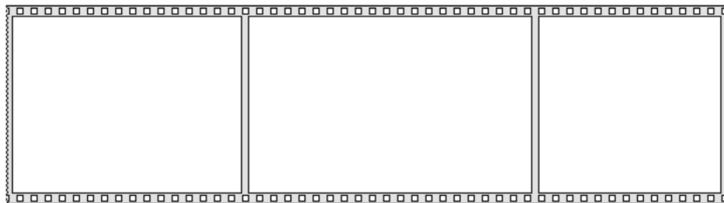
Sl. 2.2.2. Flat Sequence struktura sa tri sekvence
