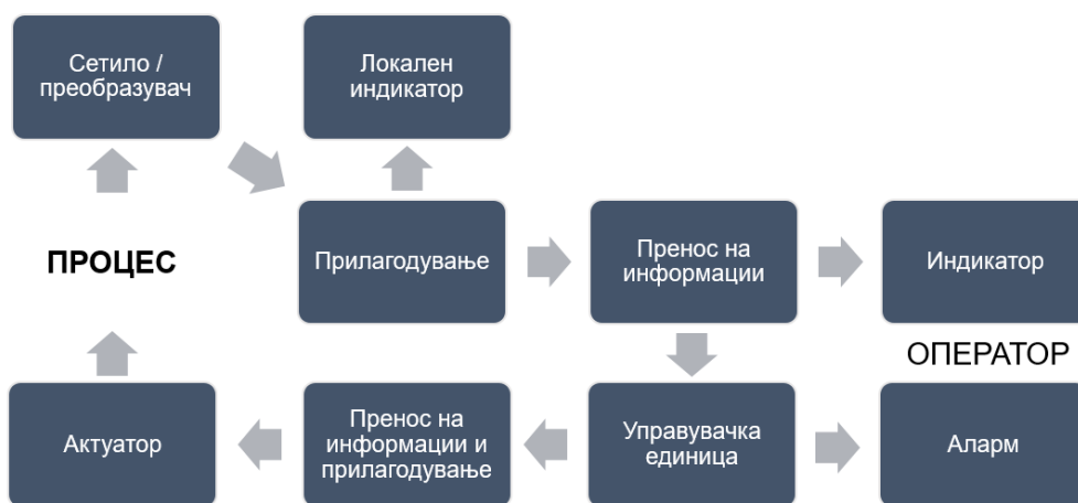
Сл. 1.2 Принципска шема на процесен мерно-управувачки систем
