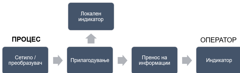
Слика 1.1 Принципска шема на процесен мерно-информациски систем
